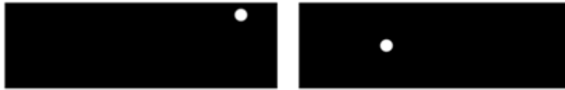
Fig. 20. Geometría de las muestras de duraluminio simuladas con 1 defecto
