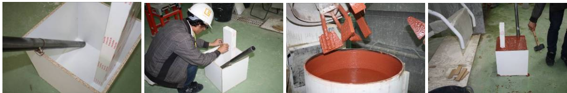
Fig. 11. Proceso de elaboración de probetas de hormigón autocompactante con defectos
