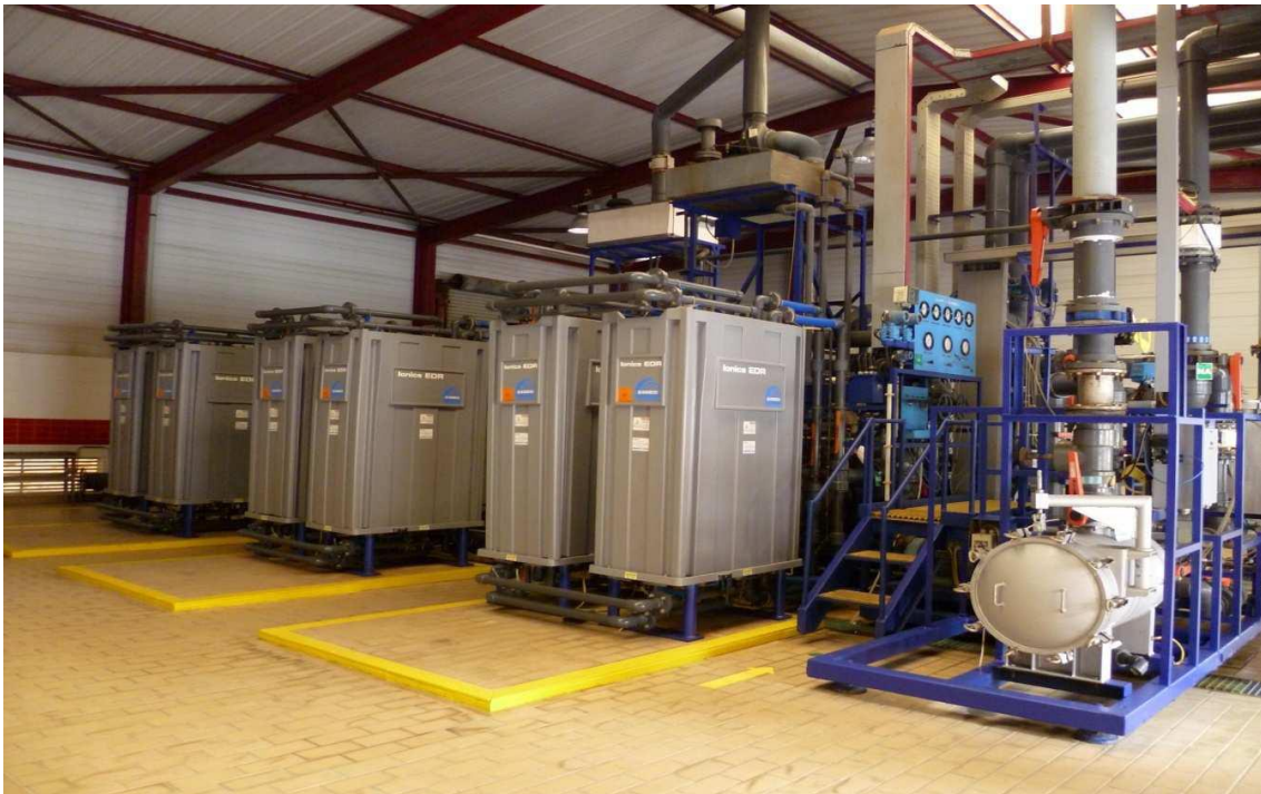
Figura 10. Planta de electrodiálisis reversible de Heineken (por cortesía de Heineken España S.A)
