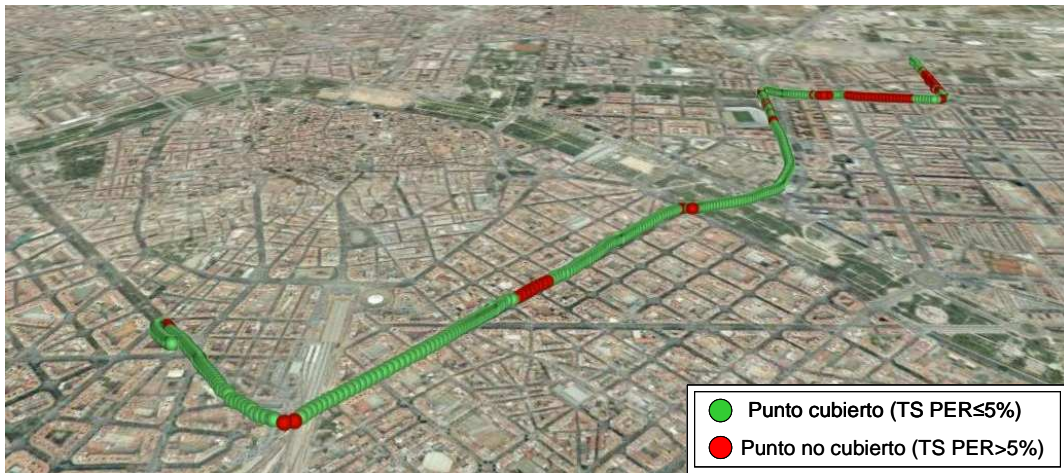
Figura 6.9. Puntos cubiertos con diversidad y separación entre antenas de 20 cm
