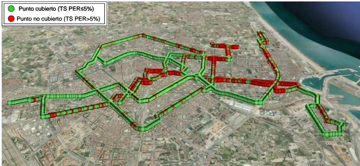
Figura 6.27. Simulación con el flujo HP de modulación jerárquica y diversidad de antenas
