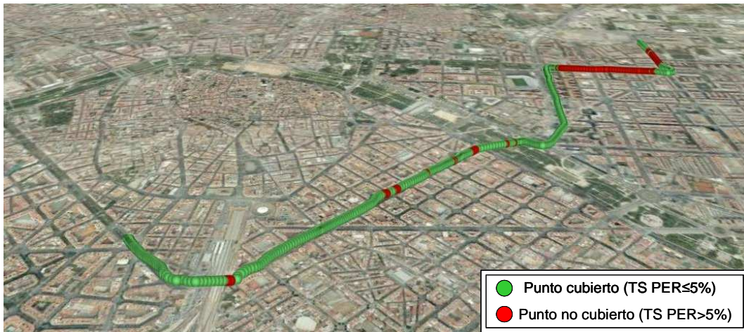
Figura 6.7. Puntos cubiertos con diversidad y separación entre antenas de 14.8 cm
