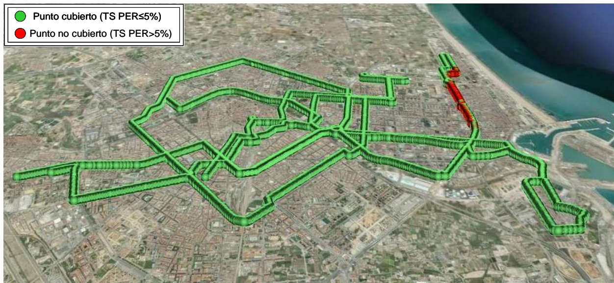
Figura 6.29. Simulación combinando las tres técnicas: modulación jerárquica, diversidad de antenas y AL-FEC ( code rate =1/2 PP=600)
