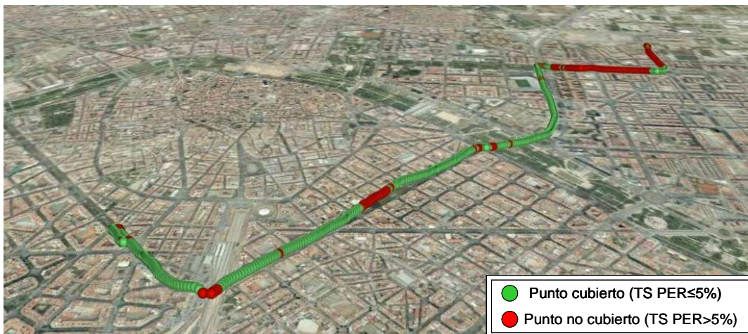
Figura 6.8. Puntos cubiertos con diversidad y separación entre antenas de 10 cm
