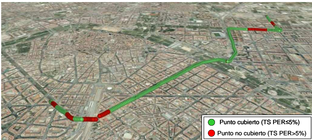
Figura 6.10. Puntos cubiertos con diversidad y separación entre antenas de 125 cm
