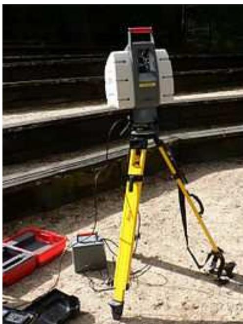
**Imagen 2. Escáner Láser Leica.**
