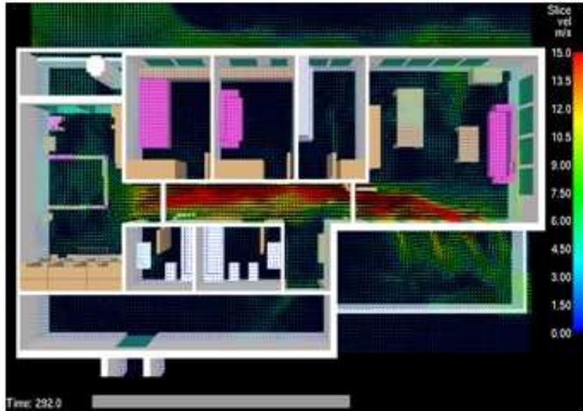
*Figura 63. Vectores indicando la velocidad del viento en el interior del escenario.*
