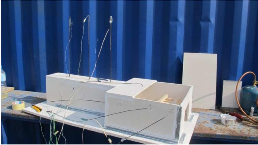
**Figura 71. Colocación de termopares por todo el escenario.**
