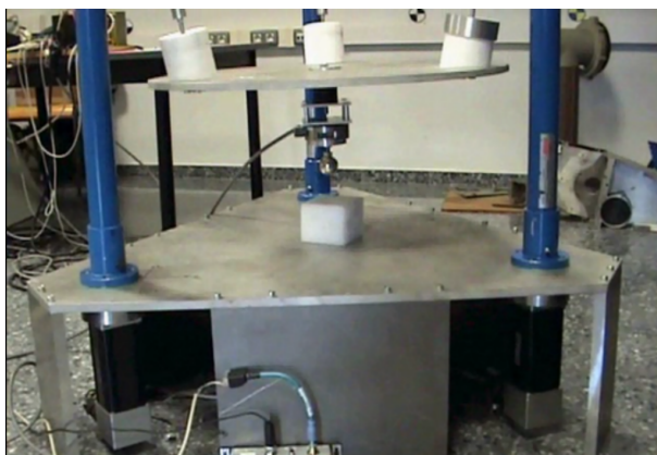
Figura 51: Robot 3PRS con sensor de fuerza
