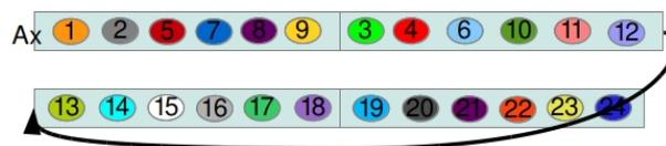
Figura 5.5: Estructura de datos  $A_x$  en CSR block
