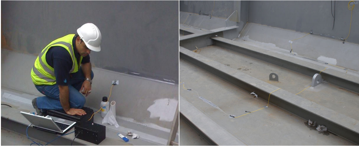
Fig.6. Conectorización de los sensores de una misma sección.
