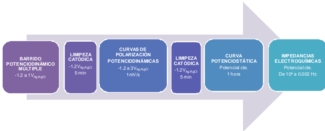
Figura 19. Esquema de las secuencias de medidas electroquímicas realizadas en el dominio anódico.
