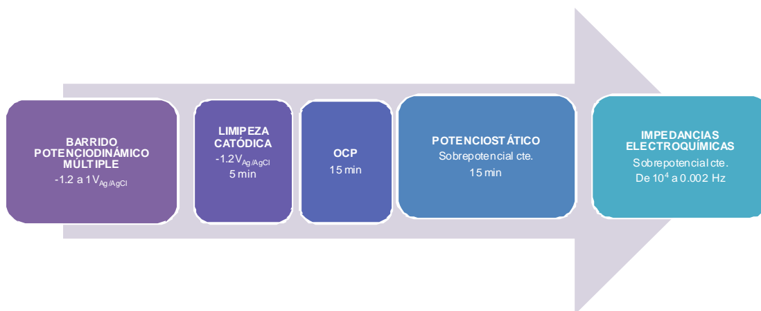
Figura 21. Esquema de las secuencias de medidas electroquímicas realizadas en el dominio catódico.
