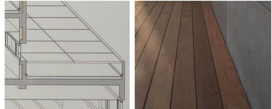
ACABADOS DE LA CUBIERTA INVERTIDA: baldosas de hormigón y entanmado de madera
