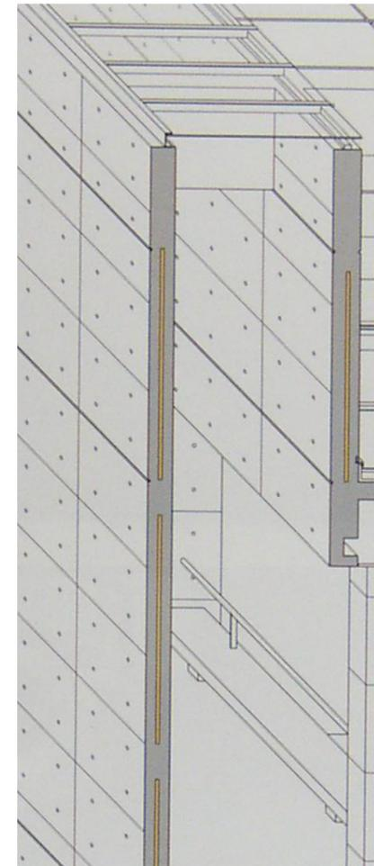
muro estructural de hormigón ejecutado a dos caras con aislamiento térmico intermedio
