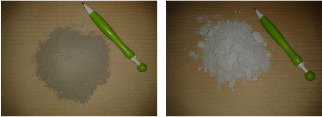
Figura 4.18.- Aspectos del cemento (izquierda) y del humo de sílice (derecha)
