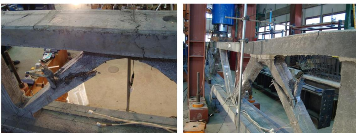
*Figura 4.45.- Vista global del fallo: Rotura de la diagonal en su zona central y en la base; rotura del cordón superior. Deflexión en la viga tras la rotura*
