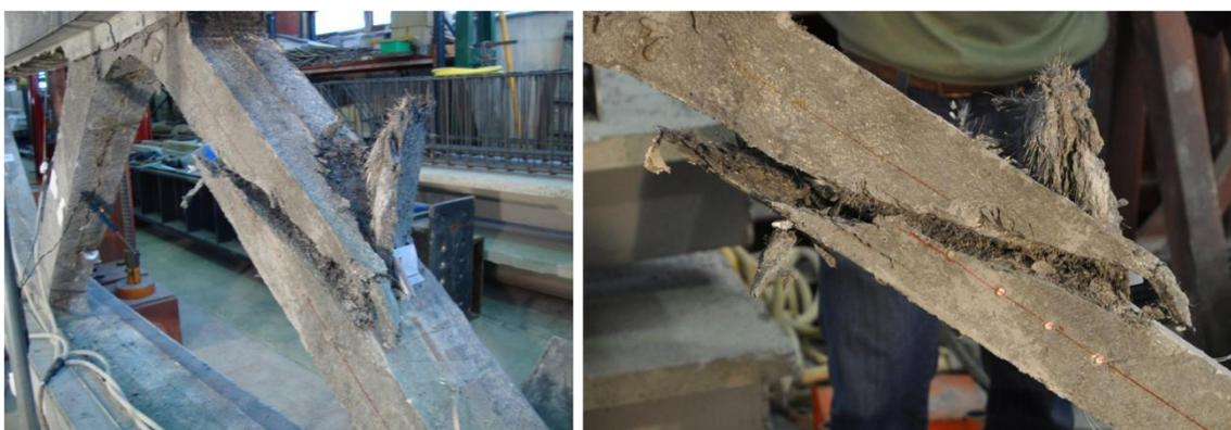
*Figura 4.46.- Detalle del fallo por la sección central de la diagonal comprimida de apoyo*
