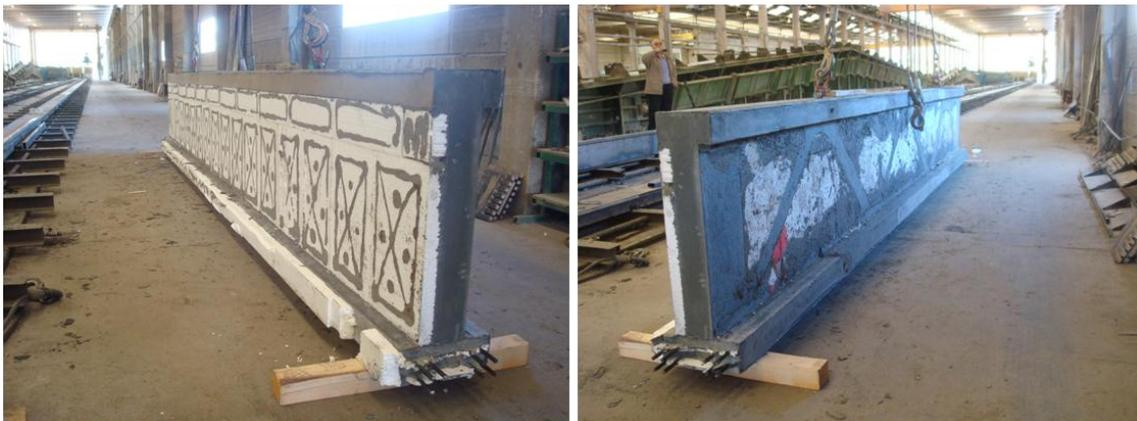
*Figura 4.16.- Celosía tras el desmoldado y destesado antes de eliminar el porexpán*
