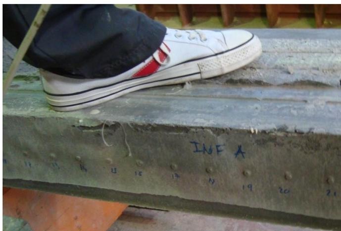
*Figura 4.34.. Disposición de puntos Demek en el cordón inferior*
