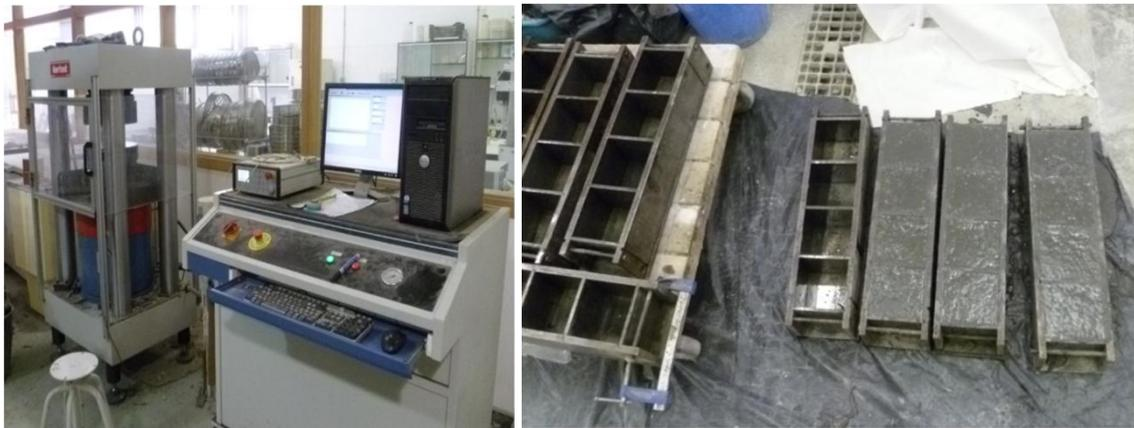
Figura 4.21.- Prensa IBERTEST para ensayos a compresión (izquierda); probetas cúbicas elaboradas (derecha)
