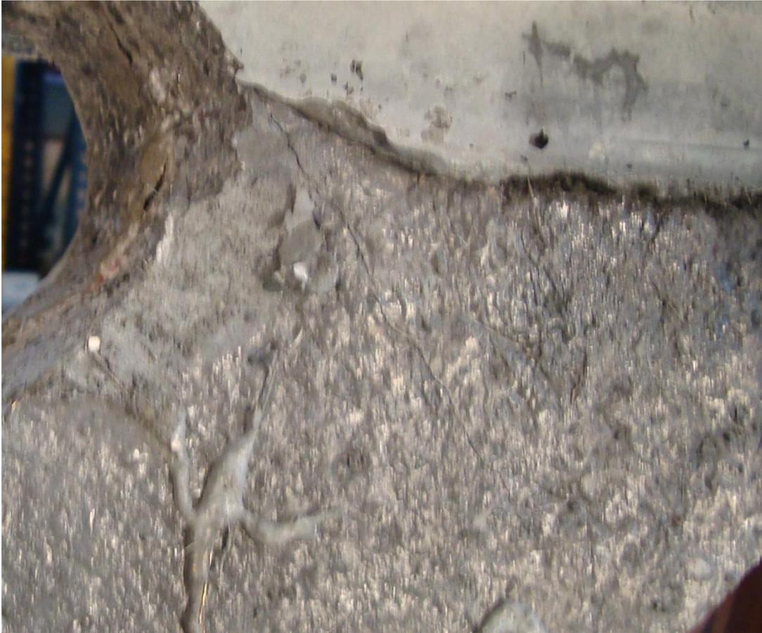
*Figura 4.43.- Carga de 100 Ton: Única fisura visible en las diagonales comprimidas durante todo el proceso (diagonal comprimida central)*
