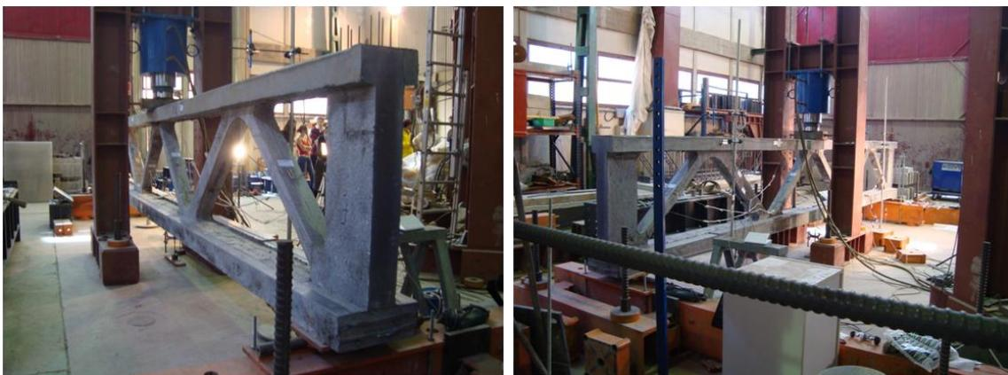
*Figura 4.17.- Celosía tras el desmoldado y destesado después de eliminar el porexpán*
