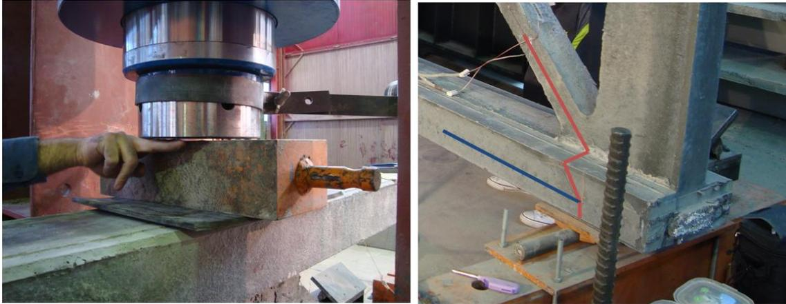
Figura 4.31.- Sistema de carga (izquierda); metodología para la ubicación del apoyo de la celosía (derecha)
