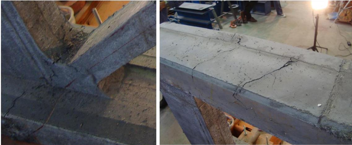
*Figura 4.47.- Detalle de la rotura en la base de la diagonal comprimida (izquierda); detalle de la rotura en el cordón superior (derecha)*
