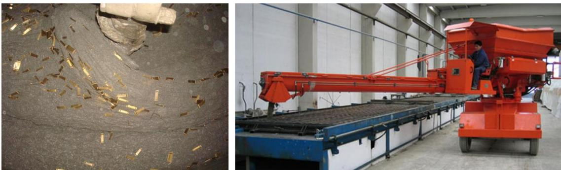
*Figura 4.14.- Fabricación del hormigón y dispersión de las fibras largas (izquierda); máquina speedy para vertido de hormigón*
