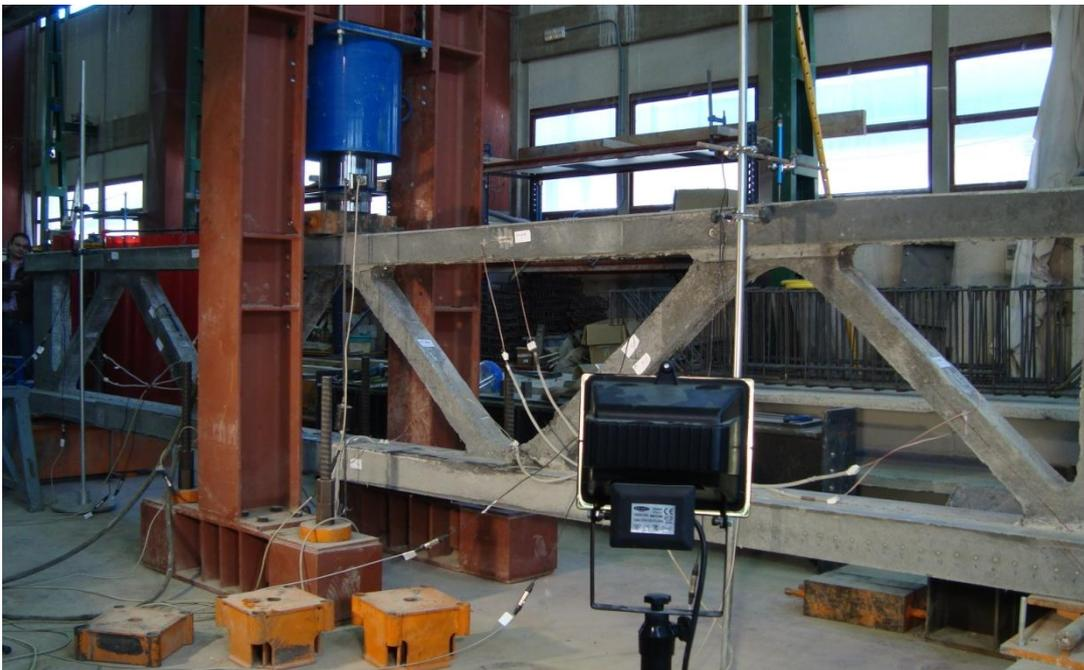
*Figura 4.44.- Deflexión de la celosía con una carga de 115 Ton de 3.7 cm en el punto central previa a la rotura.*
