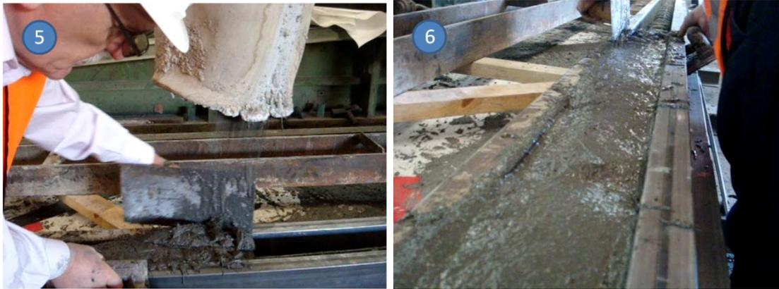
*Figura 4.15.- (1) Picado del cordón inferior; (2 y 3) Puesta de la diagonal traccionada; (4) Puesta de la zona de alma de apoyos; (5 y 6) Puesta de la segunda fase del cordón inferior*
