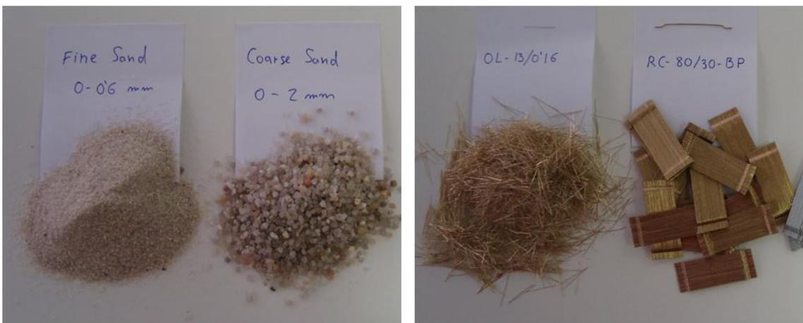
Figura 4.19.- Aspectos de las arenas (izquierda) y fibras (derecha) empleados
