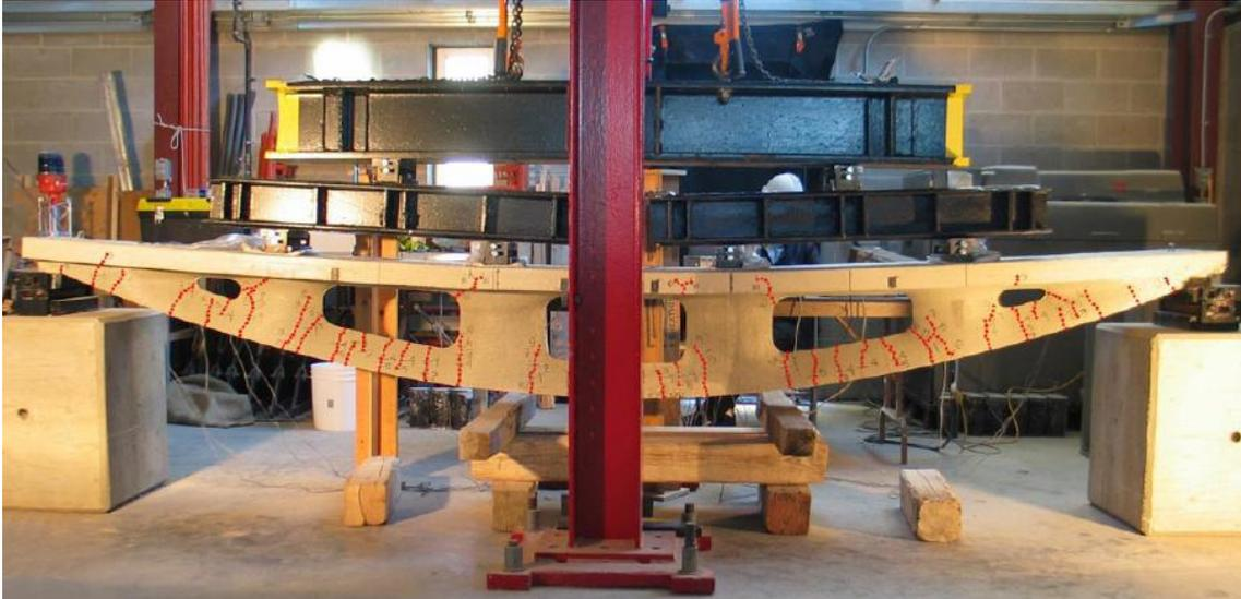
*Figura 3.35.- Celosía Vierendel de hormigón pretensado [West 2006]*
