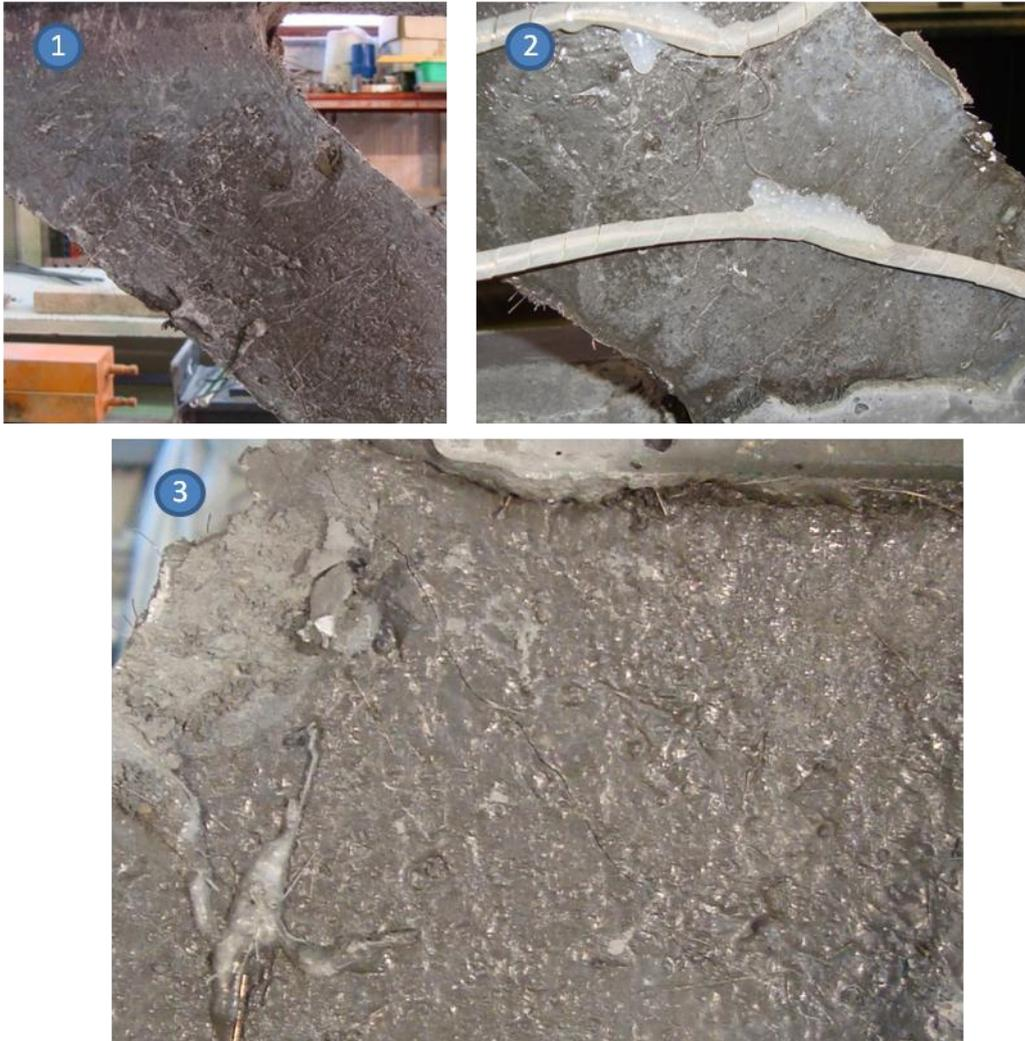
*Figura 4.42.- Carga de 80 Ton: Desarrollo del proceso de fisuración en la zona superior (1) e inferior (2) de la diagonal traccionada; (3) Aparición de la primera fisura visible sin humedecer la superficie.*
