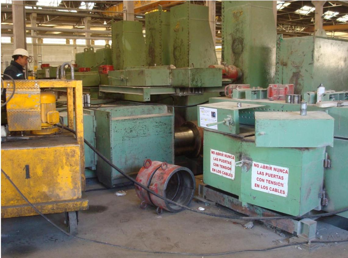
*Figura 4.28.- Sistema de pretensado y estado de los gatos hidráulicos tras quitar los collarines de seguridad (cilindros en rojo).*
