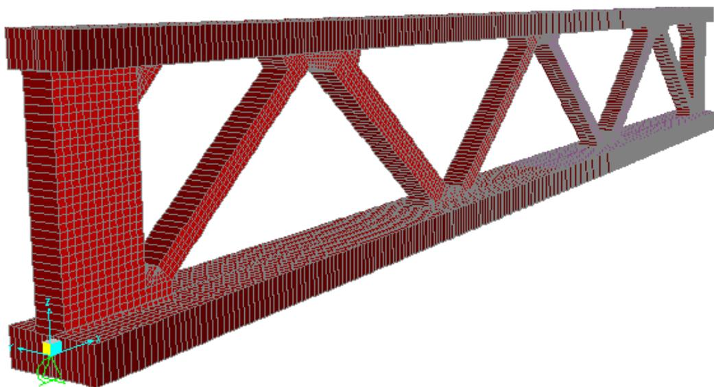
*Figura 5.40- Esquema del modelo de elementos finitos lineal utilizado en SAP2000 para la estimación de las tensiones en la junta de hormigonado*
