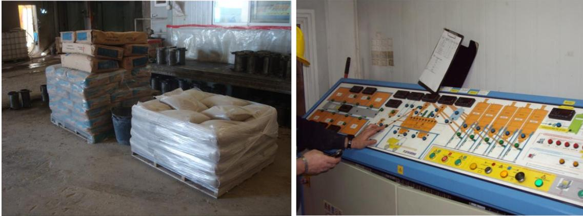
*Figura 4.12.- Acopio de materiales en fábrica y mesa para la dosificación de agua y aditivo*
