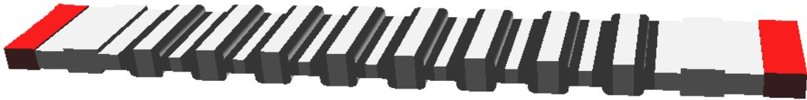
Figura 4.9: Filtro paso bajo con esquinas redondeadas en guía rectangular.
