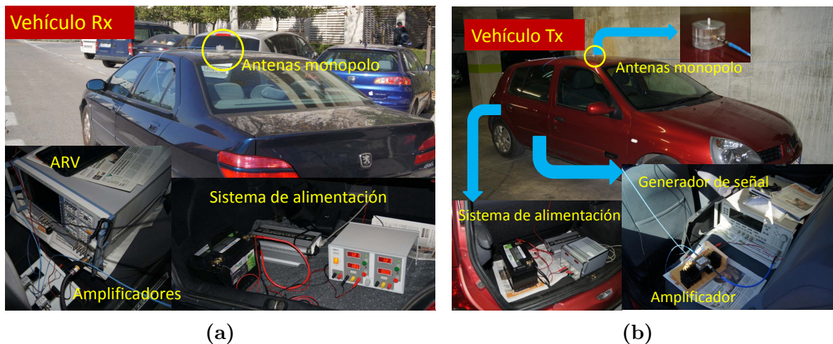
Figura 1: Imagen del vehículo (a)Rx y (b)TX junto con el equipamiento de a bordo.
