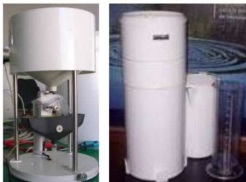
Figura 4-9. Izquierda: Pluviómetro telemétrico SAIH tipo “cubeta basculante” que drena en cubetas oscilantes acopladas, con lectura colectada en tiempo real. Derecha: Pluviómetro AEMET tipo “Hellmann” de 200 mm de capacidad con lectura diaria por operadores.
