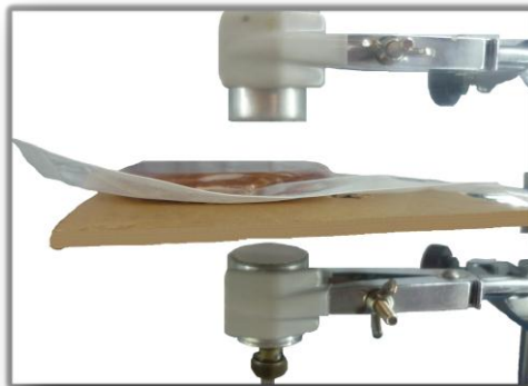
Figura 8. Medida de los ultrasonidos sin contacto en productos cárnicos crudo-curados
