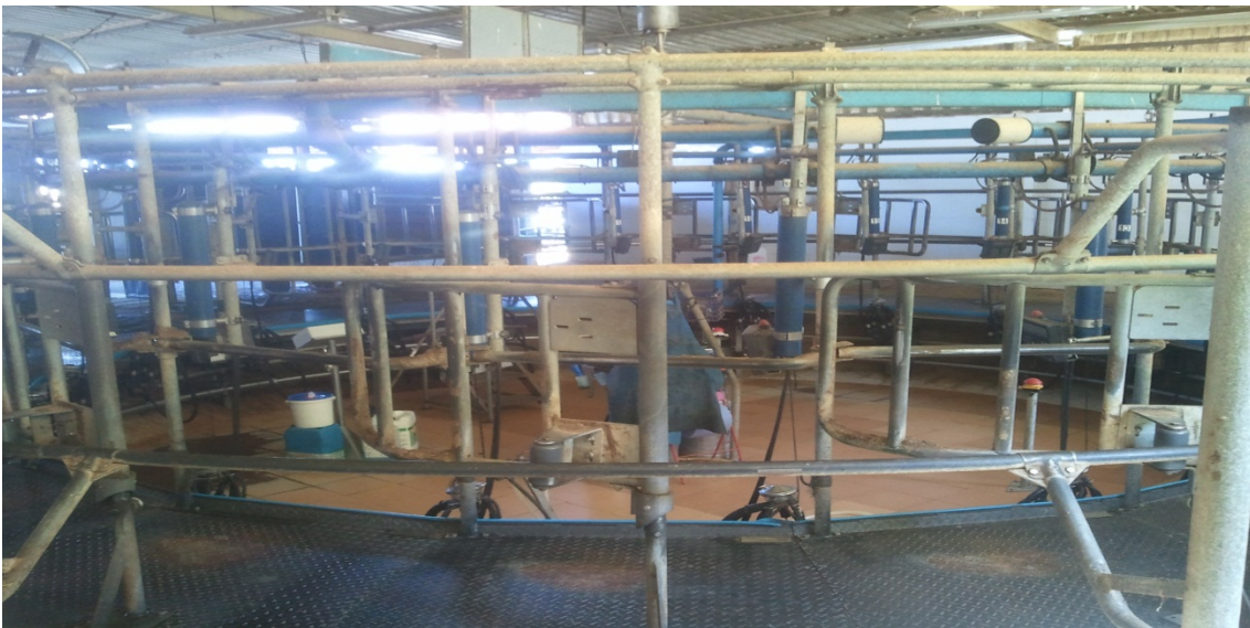
Fig. 1. Sala de ordeño rotativa de una de las explotaciones a las que asistíamos. Es el tipo de sala más común de las explotaciones que visitábamos.
