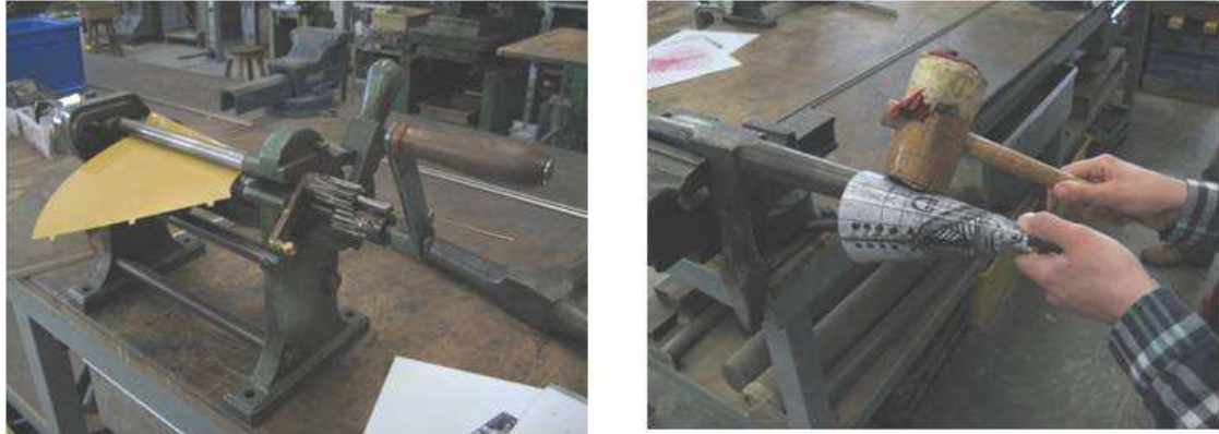
Fig. 4.3.17.- Dobladora de cilindros. Cerrando el cono apoyándose en una bigornia.
