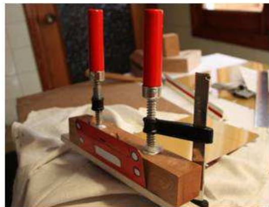
Fig. 4.3.16.- Curvado de locomotora. Doblado de chasis de auto-radio.
