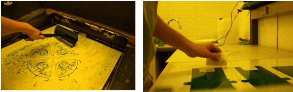
Fig. 4.3.7.- Revelado y engomado de planchas offset.
