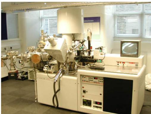
**Figura V. 4.** Espectrofotómetro de fotoemisión de rayos X utilizado para el análisis de las muestras.
