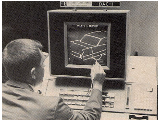
Fig 2.11- DAC-1, el primer CAD comercial de la historia, desarrollado por IBM y General Motors.
