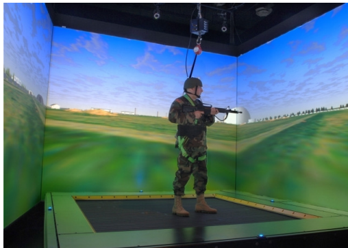
Fig 5.4 – Militar de la Armada de Estados Unidos entrenando en una CAVE con una cinta omnidireccional en el Army Research Laboratory.
