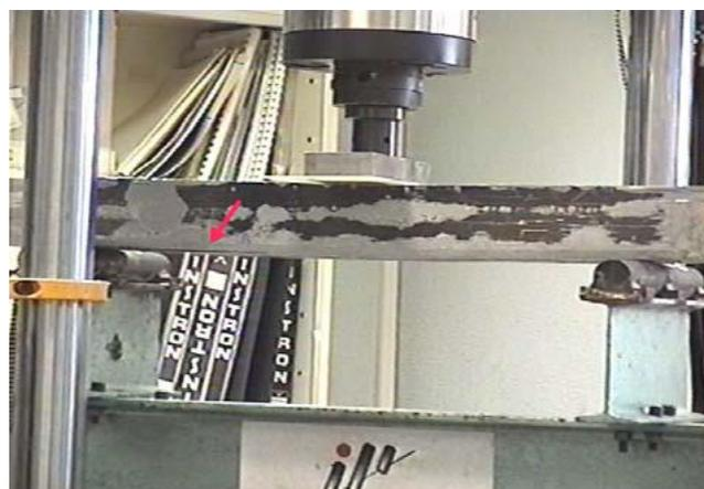
Figura 3.16 Viga con refuerzo inferior a flexión y lateral a cortadura (Geometría II)
