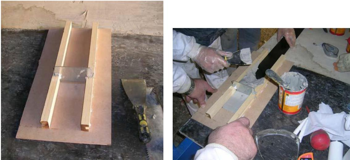
Figura 6.6 Herramienta casera para una correcta aplicación del adhesivo sobre el laminado
