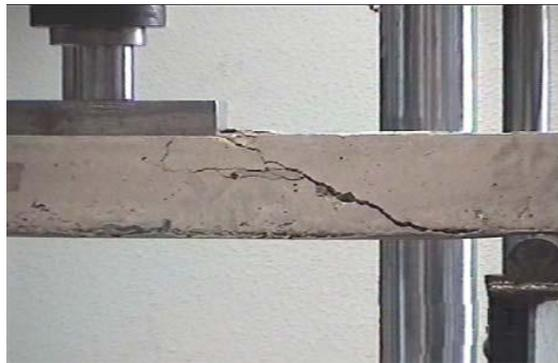
Figura 3.14 Viga con refuerzo inferior a flexión (Geometría I)
