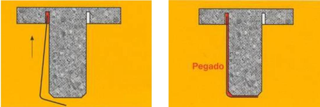
Fig. 6.14 Esquema de trabajo: Introducir en el hueco para anclaje y después, pegado sobre el soporte
