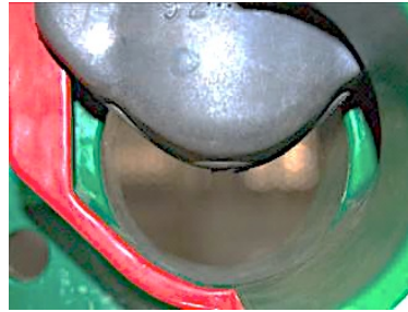
Fig. 2.28.- Sección transversal vena líquida. Compuerta abierta entre el 60 y el 70% de la sección transversal.
