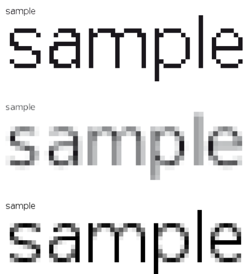
Figura 75. Comparación de un breve texto con distintas opciones, en primer lugar sin suavizado, en segundo con antialiasing y en tercero con antialiasing + mejora por hinting.
