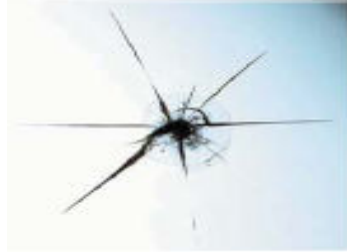
Imagen 2.5: Impacto rotura con grietas
