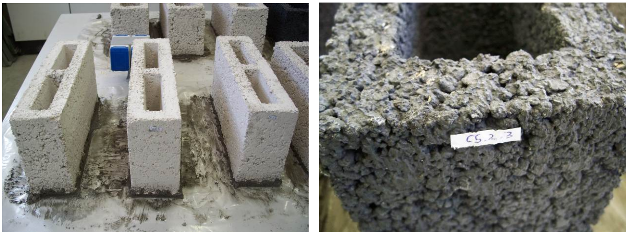
Figura 8.- Bloques vibrados de FC3R y detalle bloque manual de RHA
