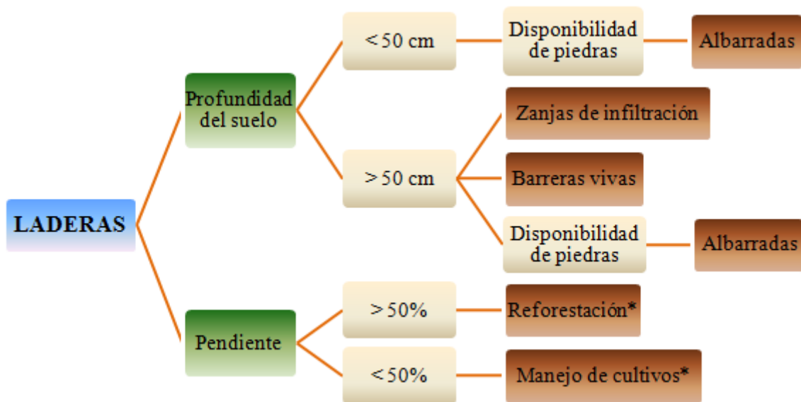
Figura 10.- Diagrama de actuaciones para laderas. Las actuaciones indicadas con * serán combinadas con albarradas, zanjas de infiltración y barreras vivas según corresponda a la profundidad del suelo.
