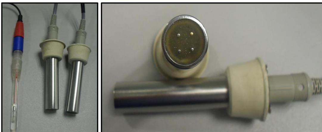
**Figura 2:** Electrodo del equipo voltamétrico (electrodo de referencia y lenguas electrónicas).
