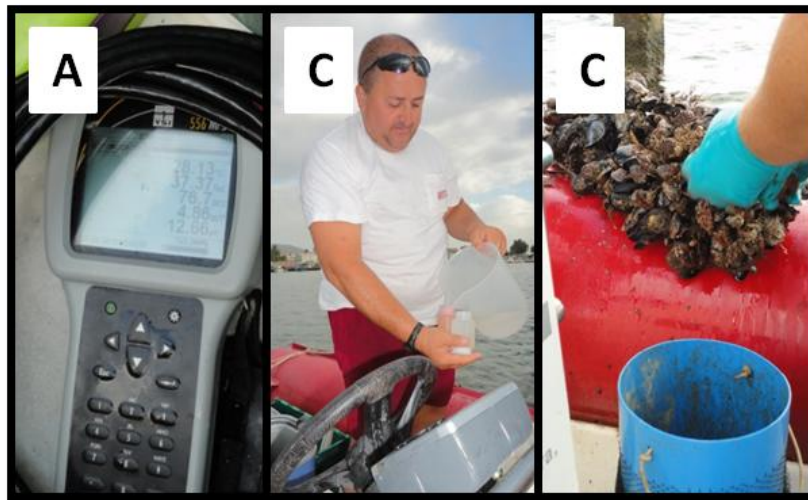
Figura 25. Sonda multiparamétrica (A). Técnico recogiendo las muestras de fitoplancton para sedimentar y para la determinación de la concentración de clorofila (B). Recogida de mejillón para determinar la presencia de toxinas (C).
