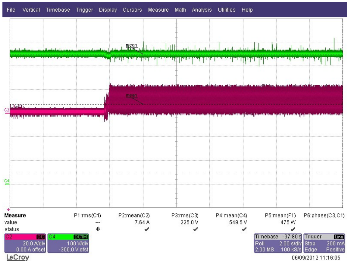
Figura 175: Respuesta ante el escalón de carga de la tensión y corriente en el bus de continua
