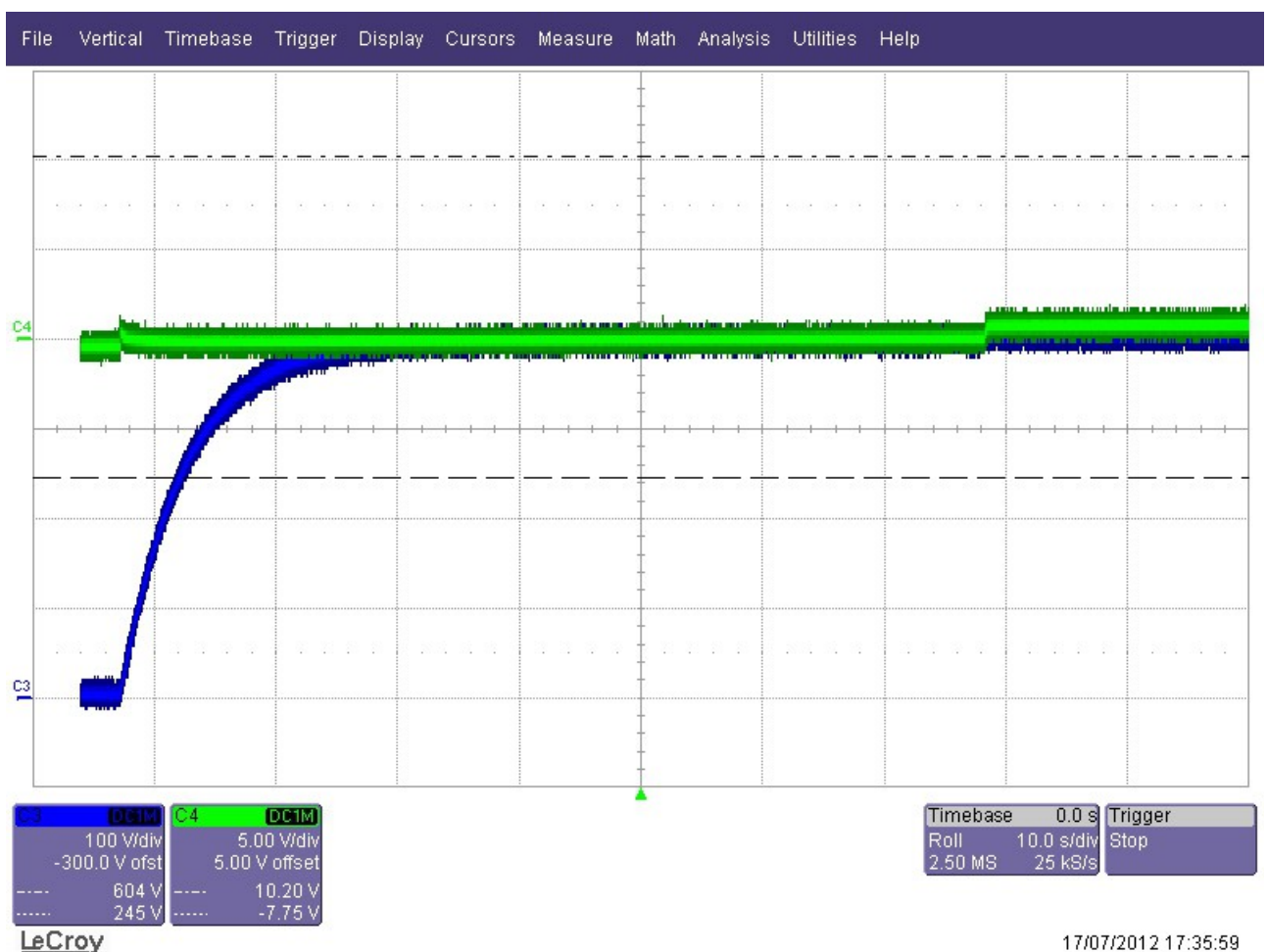
Figura 160: Tensión en la DC-Link y en Cout del Surtidor con C_{des} = 100 \text{ nF} y V_{dc} = 400 \text{ V}
