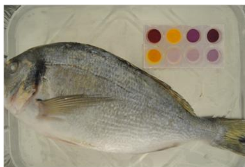
Figura 2. Preparación de una bandeja con la muestra y los reactivos colorimétricos.
