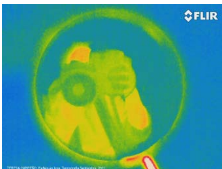
Termografía. Reflejo en lupa . Septiembre, 2011.
