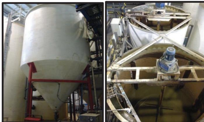
Figura 13. Tanques de precipitación-sedimentación
