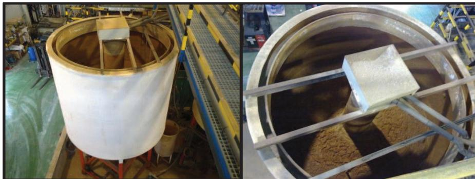
Figura 15. Espesador por gravedad
