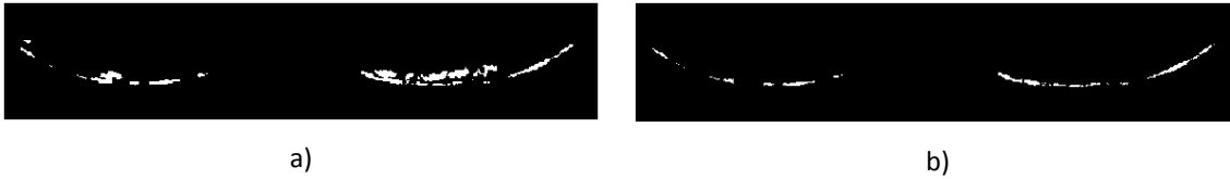
Fig. 18. a) Operación AND de 3 PPO consecutivas; b) Conjunto de inliers de una distribución cuadrática filtrados mediante RANSAC
