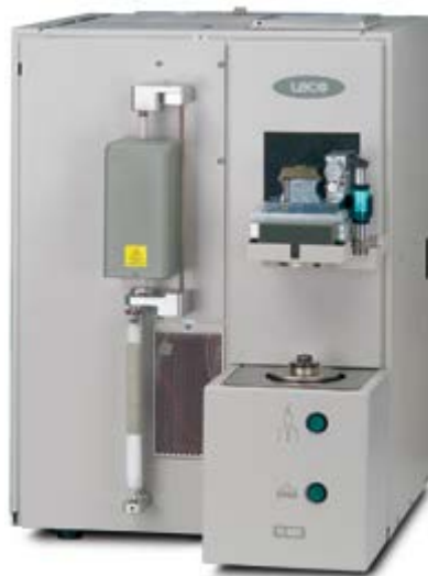
Figura 4.9. Equipo para la obtención del contenido en oxígeno y nitrógeno Leco TC400.
