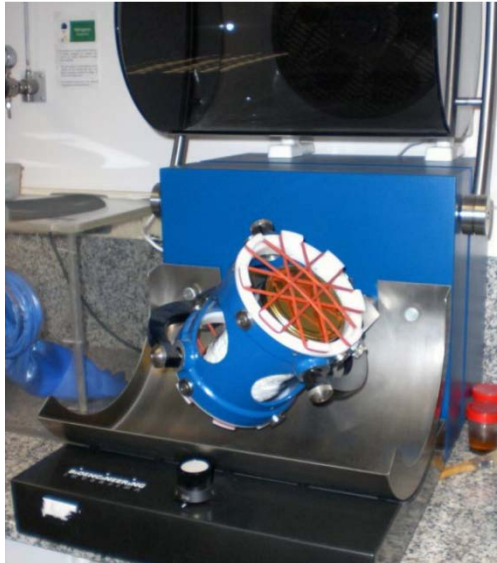
Figura 4.4. Túrbula utilizada para la mezcla elemental de polvos.
