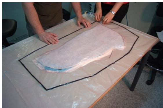
Cierre de la bolsa de vacío
