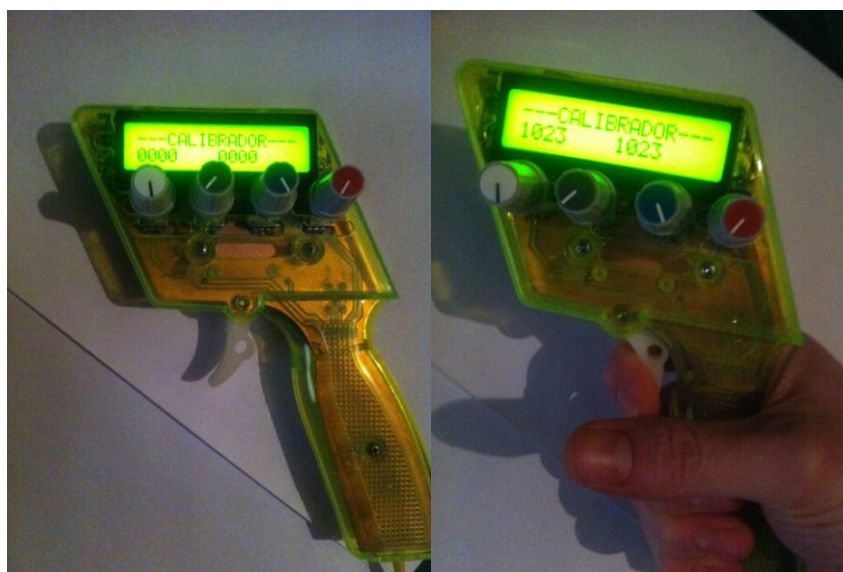
Figura 37. Ilustración del calibrado del sensor GMR.
