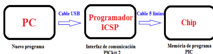
Figura 20. Diagrama de flujo de la programación del PIC.
