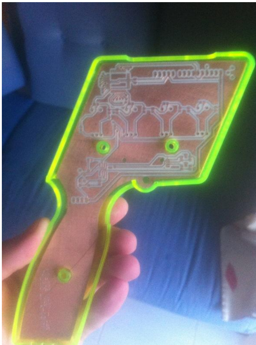
Figura 28. Ilustración de la placa impresa final fresada.
