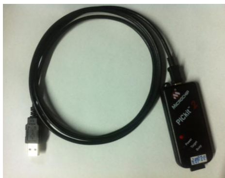
Figura 19. Programador USB PICKit 2.
