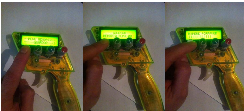
Figura 36. Ilustración de los pasos para guardado y cargado de los parámetros de configuración.
