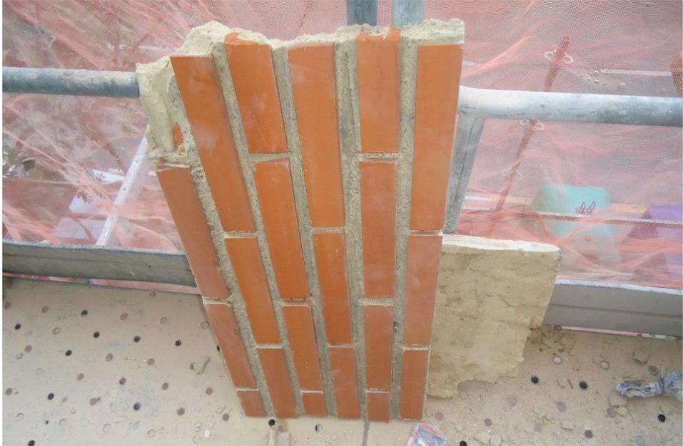
Foto A.9. Plaquetas desprendidas de los frentes de forjados. (ITE Asturias, 2012)
