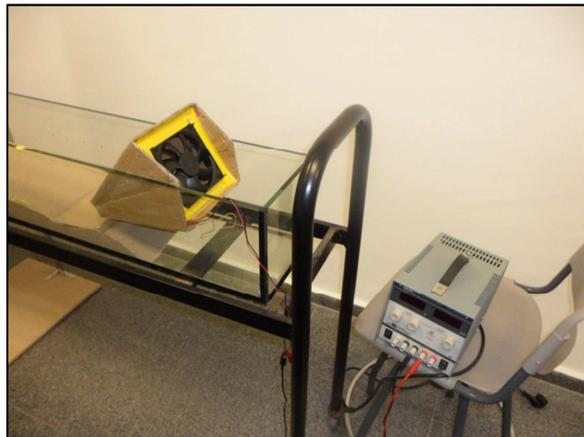
*Figura 18. Sistema generador de viento.*
