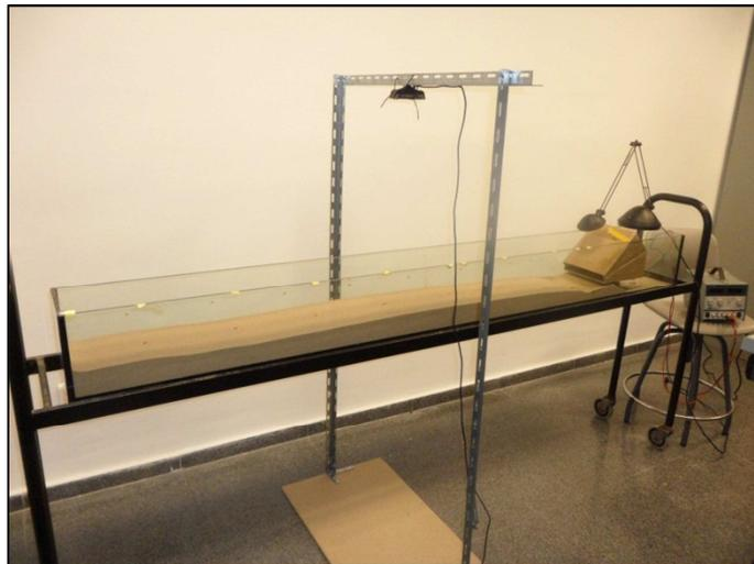
Figura 17. Túnel de viento experimental y webcam utilizada para la toma de imágenes y vídeos.
