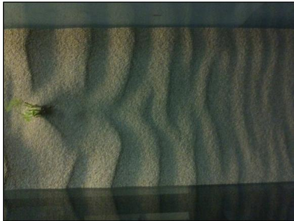
Figura 36. Reconstrucción del patrón de ripples detrás del objeto de 1 cm de diámetro.
