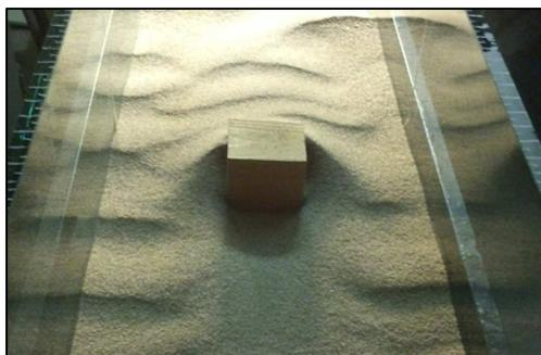
Figura 39. Obstáculo de 5 cm de ancho. Ausencia de ripples a sotavento.
