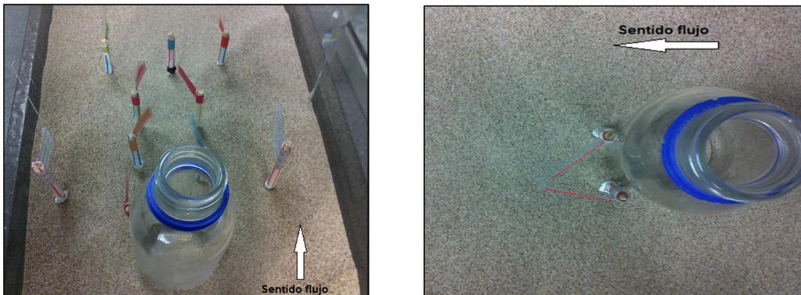
Figura 30. Medidas experimentales de la dirección viento alrededor de obstáculo circular.
