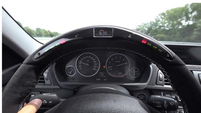
**Figura 28.** Volante inteligente. Indicador OLED
