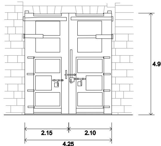
Fotografía del estado actual de la puerta Oeste del Salón Columnario tal y como quedó después de la intervención de E. Rieta. Junto a ella, presento un plano de detalle del alzado de la puerta por su intradós, debidamente acotada.
