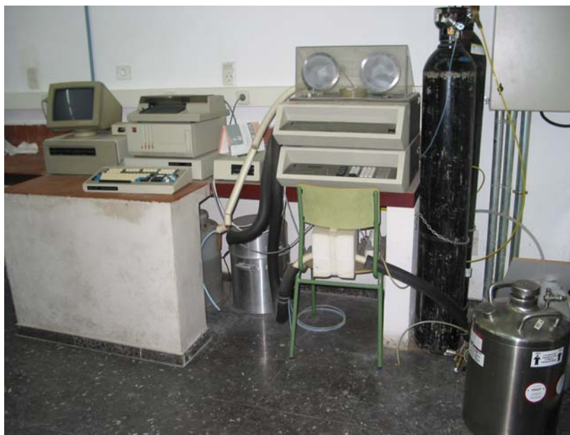
Figura 2.2 Equipo experimental DSC 4 (Perkin Elmer) utilizado en esta Tesis
