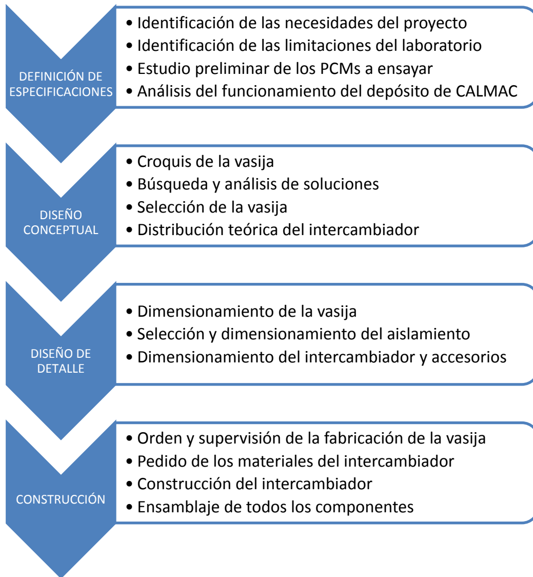
Figura 82. Resumen del proceso de diseño del depósito COMPACTO
