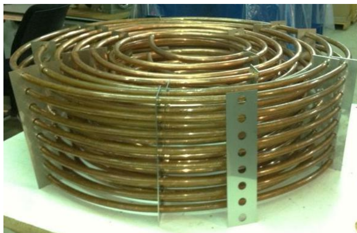
Figura 96. Resultado tras el ensamblado de los tubos y de las pletinas
