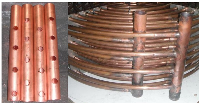
Figura 98. Colectores secundarios tras el taladrado/extrusión y soldados a los tubos
