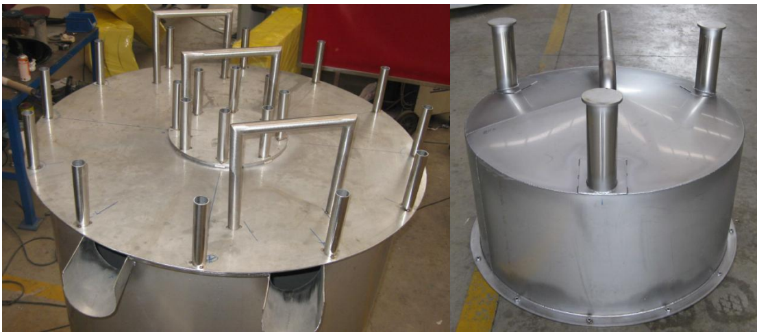
Figura 92. Fabricación de la vasija en las instalaciones de PROMINOX
