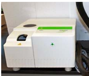
Figura 27. Fotografía del calorímetro diferencial de barrido Mettler-Toledo DSC821e.
