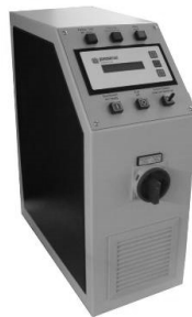
Figura 23. Fotografía del generador de frecuencia y controlador de parámetros.
