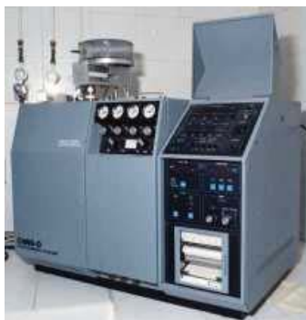
Figura 26. Fotografía del analizador elemental Carlo Erba modelo CHNS-O EA1108, provisto de automuestrador
