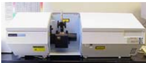
Figura 25. Fotografía del equipo FTIR con el accesorio ATR para la caracterización química de los cambios superficiales.
