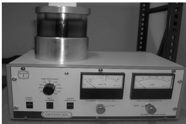
Figura 29. Fotografía del equipo empleado para la metalización de las muestras mediante sputtering .
