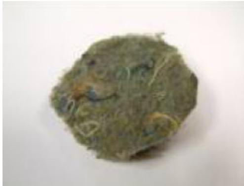
**Figura 2.14.** Material compuesto por fibras textiles recicladas.
