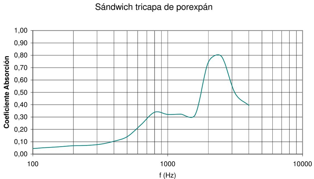
**Figura 4.17.** Coeficiente de absorción acústica del sándwich tricapa de porexpán.
