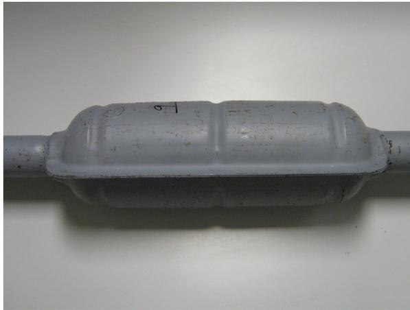
**Figura 5.21.** Filtro acústico en tubo de escape.
