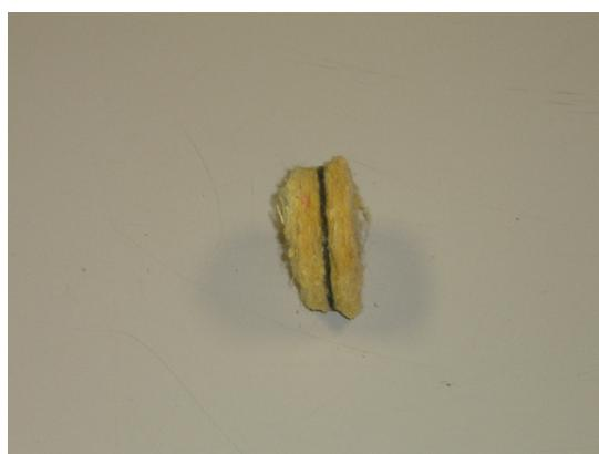
**Figura 2.12.** Sándwich tricapa de lana de roca y capa intermedia de lámina viscoelástica.
