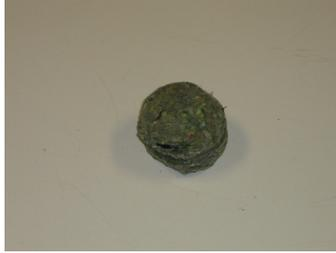
**Figura 4.8.** Sándwich reciclado tricapa de fibras textiles.
