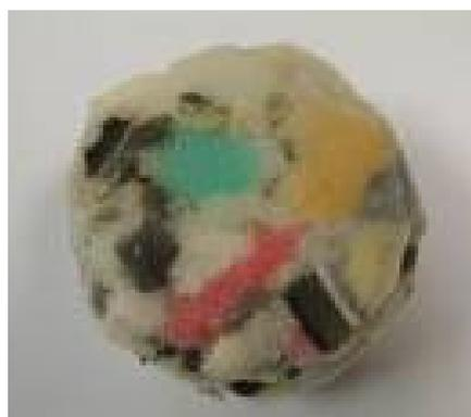
**Figura 2.16.** Material compuesto por residuos textiles reciclados.
