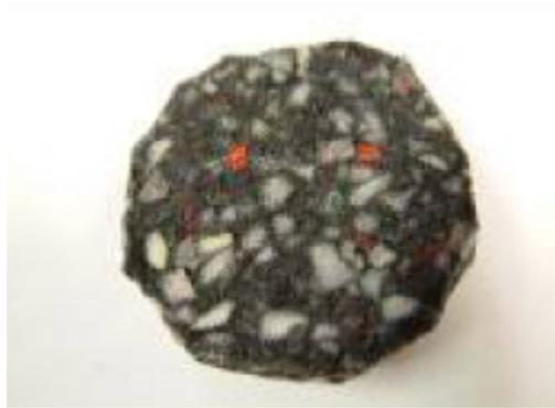
**Figura 2.15.** Material compuesto por residuos textiles reciclados.
