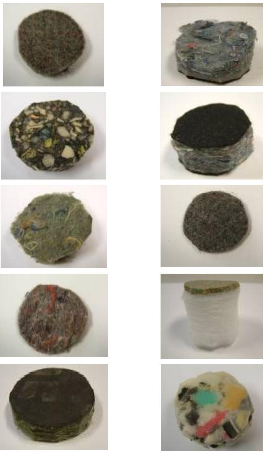
**Figura I.8.** Muestras de diversos materiales provenientes del reciclado de la industrial textil.
