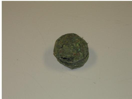
**Figura 2.9.** Sándwich reciclado tricapa compuesto de fibras textiles.
