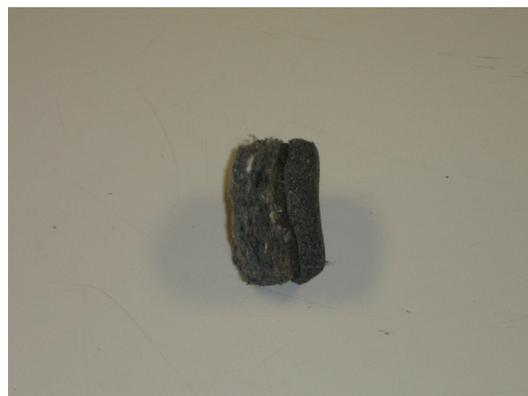
**Figura 2.10.** Sándwich reciclado tricapa a partir de fibras recicladas.
