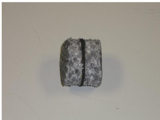
**Figura 2.11.** Sándwich tricapa de porexpán y capa intermedia de lámina viscoelástica.
