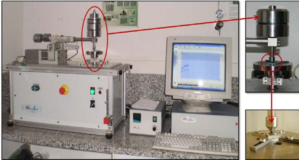
Fig. 54 Tribómetro Microtest modelo MT2/60/SCM/T con detalle del brazo porta pin y sistema de sujeción de la muestra.
