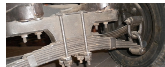
Fig. 93 y 94. Amortiguación por ballestas en carroza del Museo y en la de La Piedad
