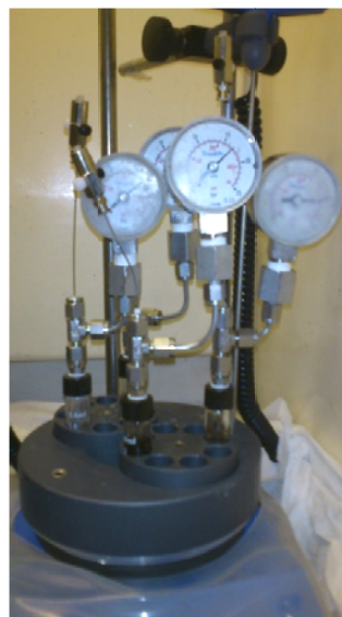
Figura 21 - Montaje con 4 reacciones batch en paralelo
