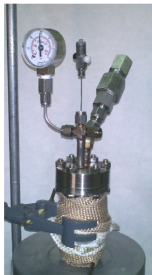
Figura 23 - Reactor autoclave sobre soporte tipo camisa
