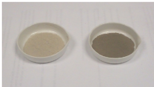
Figura 18 - Muestras de 0.75%Pd/Al 2 O 3 -B (izq.) y 1.5%Pd/Al 2 O 3 -B (der.) calcinadas
