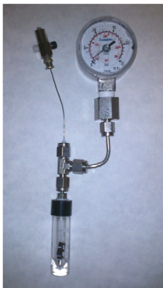
Figura 20 - Micro-reactor de vidrio de 2.5ml
