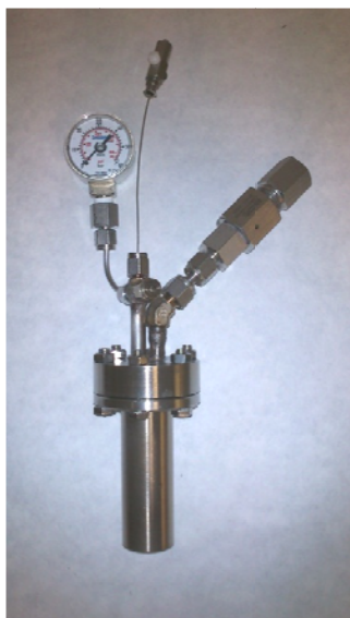
Figura 22 - Reactor autoclave de acero de 15ml
