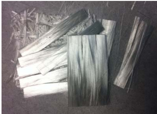
Figura 3.1. Tejido de fibra de vidrio tipo 0,90,0. Compuesto por fibras largas en 0 y 90 y en la tercera capa, fibras cortas tipo mat.
