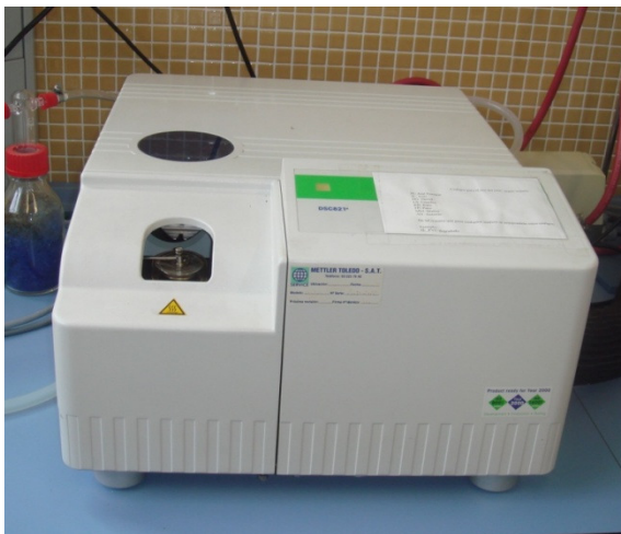
Figura 42. Imagen del DSC utilizado: Mettler-Toledo 821°. Detalle del crisol o portamuestras
