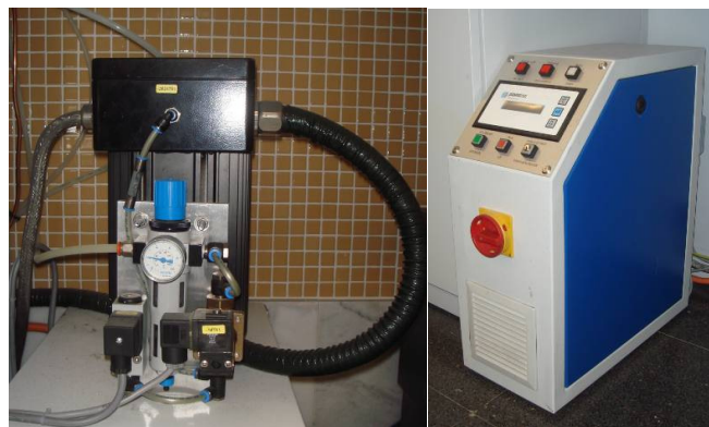
Figura 39. Generador y grupo regulador de aire comprimido y generador de frecuencia y controlador de parámetros.
