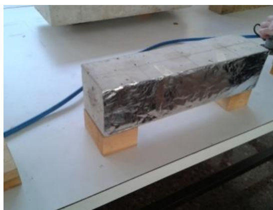
Figura 5.17 Probeta con papel metálico y con calzos de madera.
