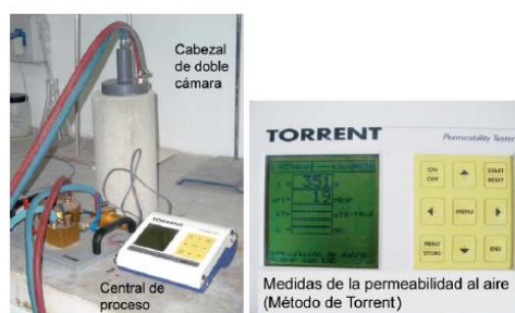
Figura 2.7 Equipo de Torrent para la determinación de la permeabilidad al aire del hormigón de recubrimiento (Fernández, 2009b).
