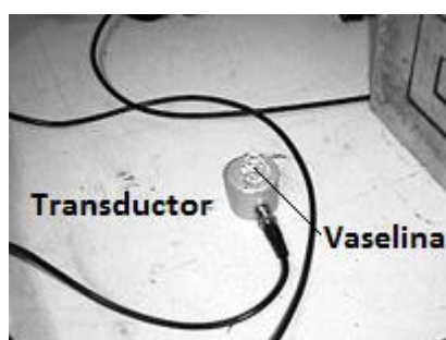
Figura 4.2 Antena de medición untada con vaselina ( www.civilgeeks.com )
