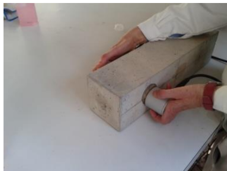
Figura 5.22 Colocación de los transductores del aparato de ultrasonidos sobre una de las probetas.
