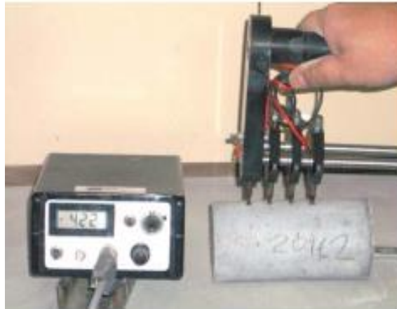
Figura 2.10 Medición de la resistividad eléctrica por método de los electrodos puntuales (Fernández, 2009b).
