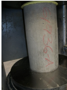
Fig. 1.8. Ensayo de rotura a compresión.
