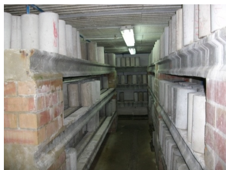
Fig. 1.6. Curado de probetas en cámara húmeda.
