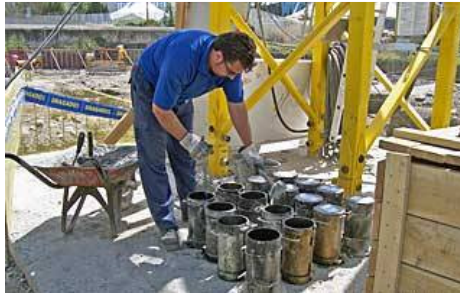
Fig. 1.2. Fabricación de probetas de hormigón.
