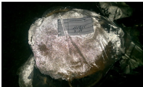
Fig. 1.3. Probeta de hormigón con arpillera húmeda y bolsa de plástico.
