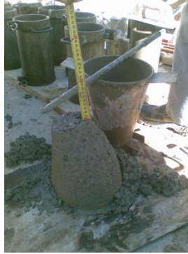
Fig. 1.1. Ensayo de determinación de la consistencia del hormigón.
