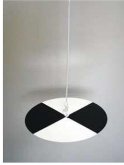
**Figura 3-1. Determinación de la profundidad de Secchi**
