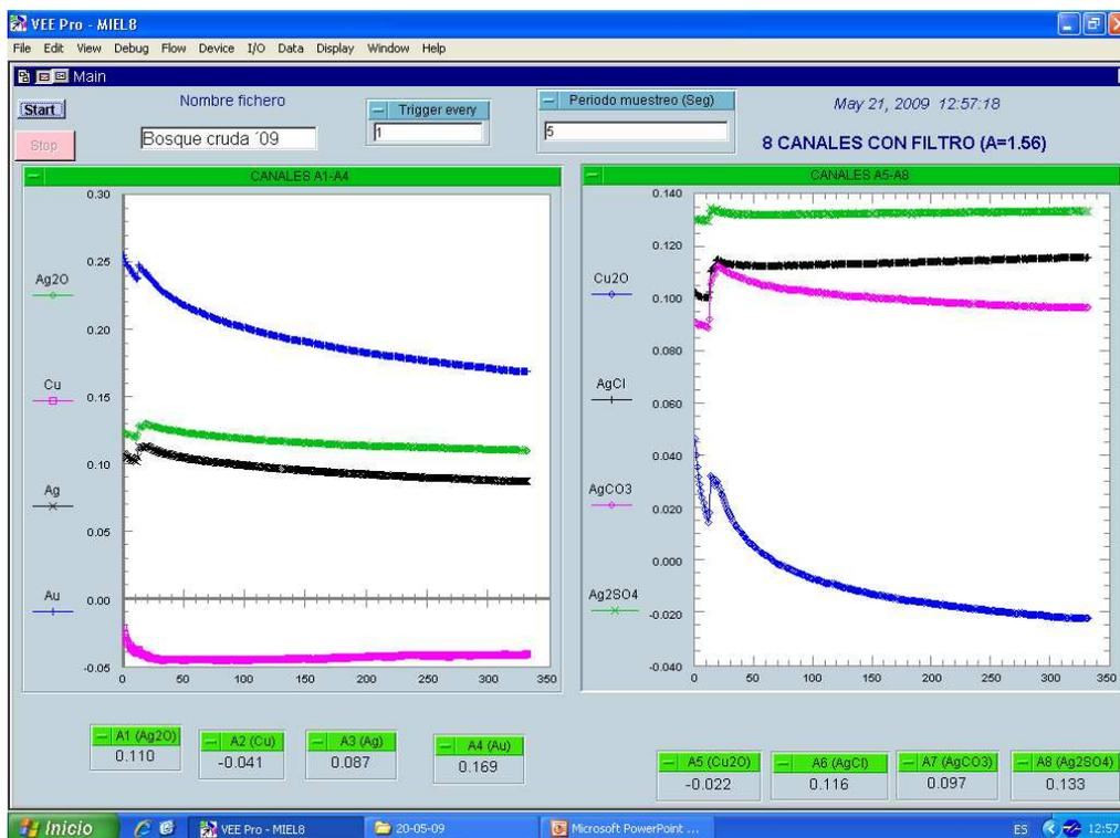
Figura 6-5. Ejemplo de la representación en pantalla del ordenador de las señales potenciométricas de algunos electrodos.
