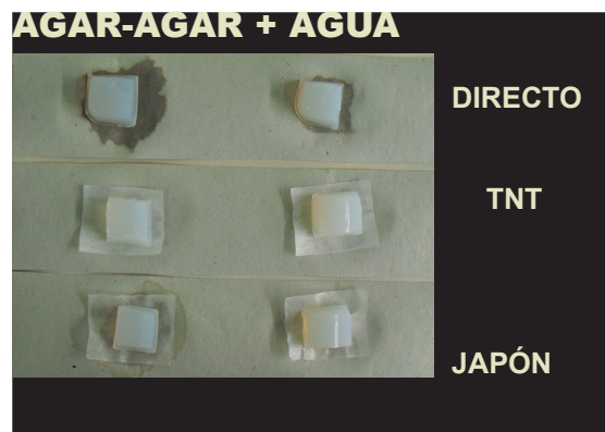
Imagen 35. Proporciones (lectura izda. dcha) 2 - 3g/100 ml. Estado de las mezclas tras 24 horas. No se produce adhesión al sustrato.
