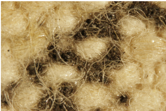
Imagen 19. Microfotografía a 16x. Ataque fúngico en soporte celulósico.
