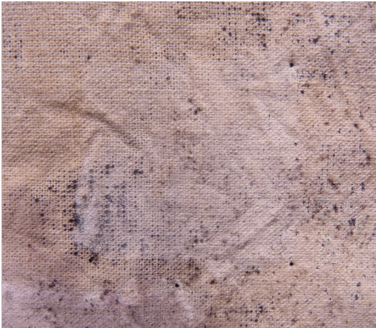
Imagen 49. Estado del soporte de la zona tratada con Fungusol® al 3% en agua. Se aprecia capa blanquecina general en la zona tratada.
