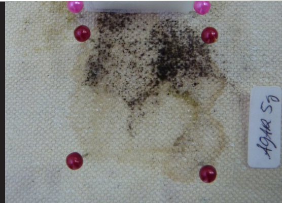
Imagen 23. Estado del soporte tras la eliminación. Aparición de cercos, siendo este el único caso.
