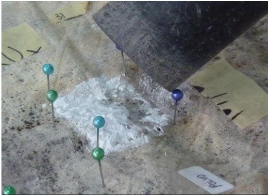
Imagen 9. Eliminación de Fungusol® tras tres horas de actuación, por medio de aspiración de la zona.
