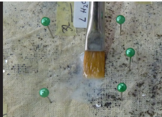
Imagen 4. Aplicación disolución en etanol de Fungusol®. Se observa el mojado excesivo del soporte textil.
