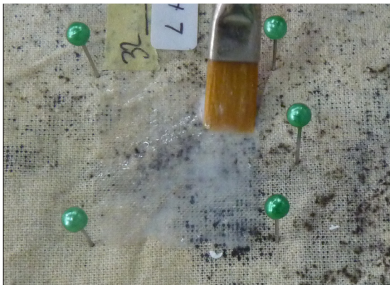
Imagen 3. Aplicación disolución acuosa de Fungusol®. Se observa la alta tensión superficial de líquido.
