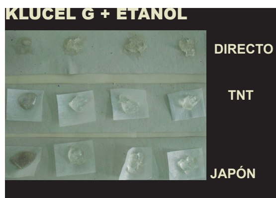
Imagen 29. Proporciones (lectura izda. dcha) 5-9-10-15g/100 ml. Estado de las mezclas tras 3 horas.
