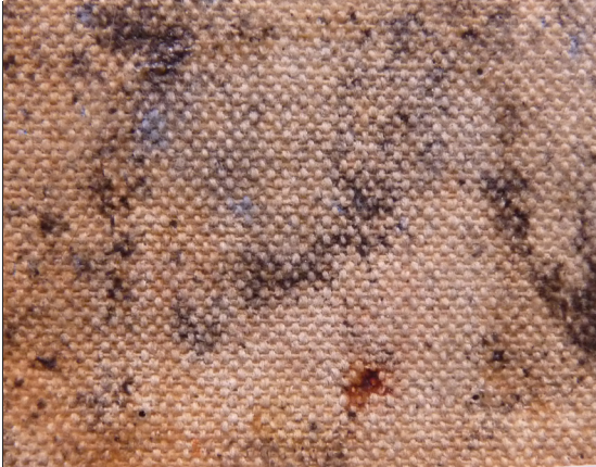
Imagen 57. Estado del soporte textil tras el tratamiento con Ácido bórico al 3% en Klucel G® agua. Se aprecia la limpieza agresiva.
