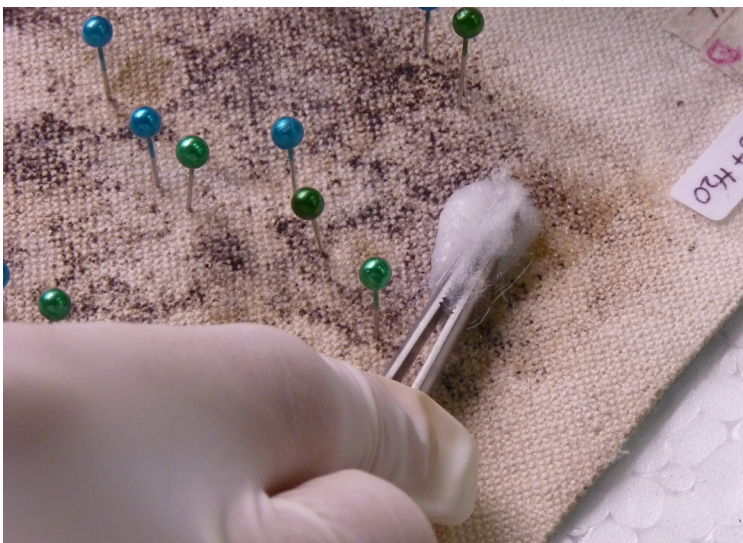
Imagen 69 . Humectación del soporte textil para medir el pH incorporado por los fungicidas
