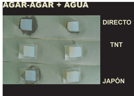
Imagen 31. Proporciones (lectura izda. dcha) 2 - 3g/100 ml. Estado de las mezclas tras 3 horas.
