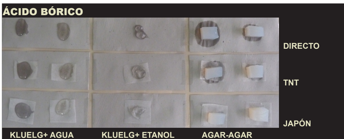
Imagen 43. Proporciones (lectura izda. dcha) 10-15g/100 ml. 5g/100 ml. 2- 3g/100 ml. Estado de las mezclas tras 30 minutos.
